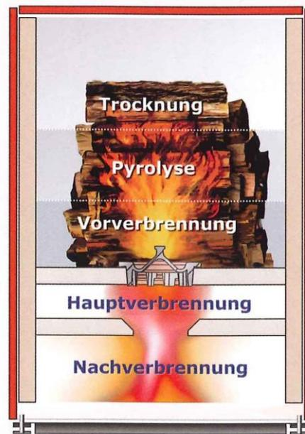
Das Holz wird dem Heizkessel chargenweise zugeführt und durch die im Betrieb entstehende Verbrennungswärme kontinuierlich vergast. Der Kessel ist durch eine Brennerplatte aus feuerfester Keramik in eine Ober- und eine Unterkammer geteilt. In der Oberkammer liegt das Stückholz auf der Brennerplatte geschichtet. Die Oberkammer ist, abgesehen von der Einfüllöffnung, nach oben hin geschlossen.
